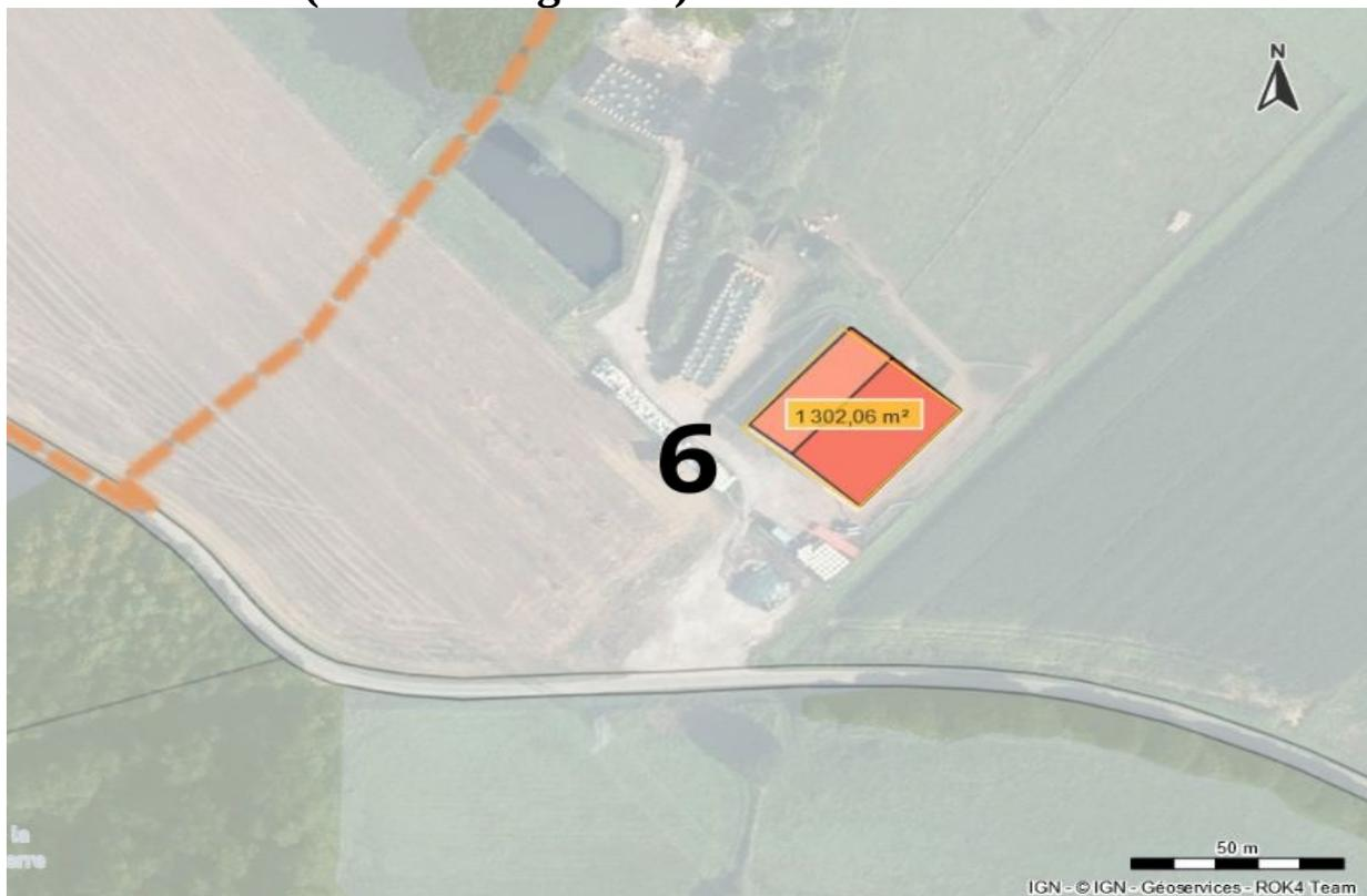
Pans de toiture ayant a priori un potentiel de production photovoltaïque intéressant (sous réserve qu'il n'y ait pas d'ombrage à proximité, pas de toiture amiantée, pas d'obstacles sur le toit, que la charpente puisse supporter 14kg/m<sup>2</sup> supplémentaires)
